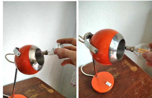
Abbildung 1: Dein neues Leuchtmittel muss zur Lampe passen. Nimm die alte Birne mit und achte beim Einkauf auf die richtige Fassung oder den richtigen Sockel!
