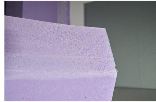
Abbildung 27: Schnittkante nach dem Schleifen
