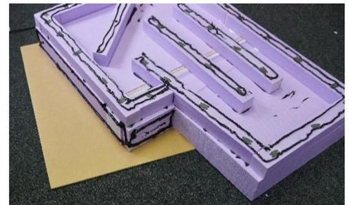
Abbildung 19: Rückwand des Lüftungskanals mit aufgebrachtem Montagekleber
