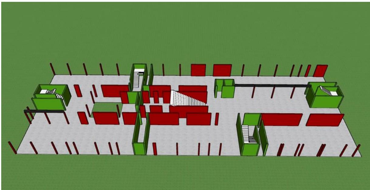
**Abbildung 6:** Grundriss Neubau Neue Grundschule Raunheim: überwiegend Holzkonstruktion, massive Stahlbetonkonstruktion zur Aussteifung und thermische Speichermasse (grüne Bauteile), massive Holzkonstruktionen (rote Bauteile),
