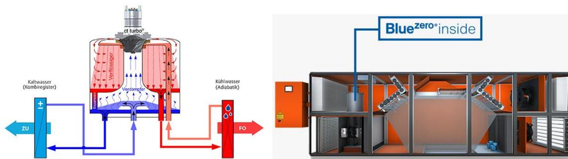
**Abbildung 7: Kompressionskältemaschine mit CO<sub>2</sub> als Kältemittel. Beispiel für ein Lüftungsgärat mit integrierter Kühlfunktion. Quelle: Menerga.**
