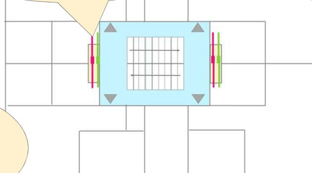
Wartung vereinfachen: zum Beispiel können Schalldämpfer und Volumenstromregler auch im Schacht zum Stiegenhaus eingebaut werden.
