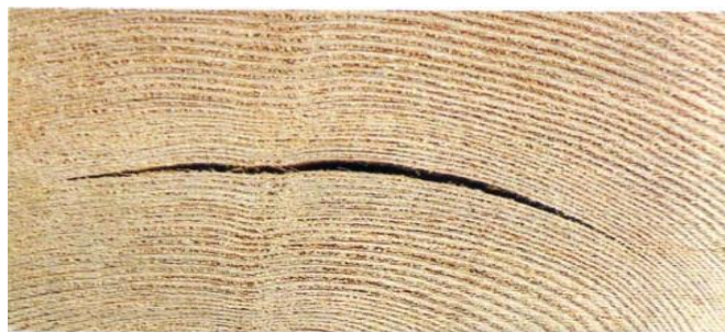
Abbildung 6: Ringschäle im Holzstamm entlang des Jahrringes 36
