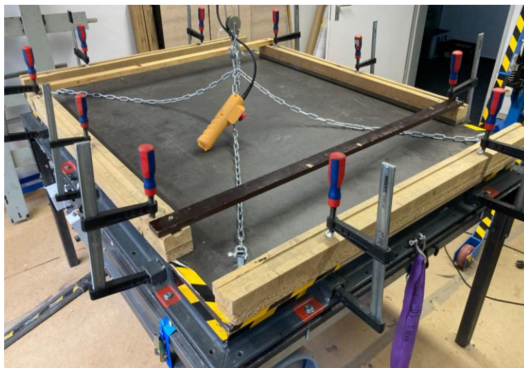
Abbildung 29: Messstand mit aufgespanntem luftdichten Deckel zur Messung der Messstandsleckage
