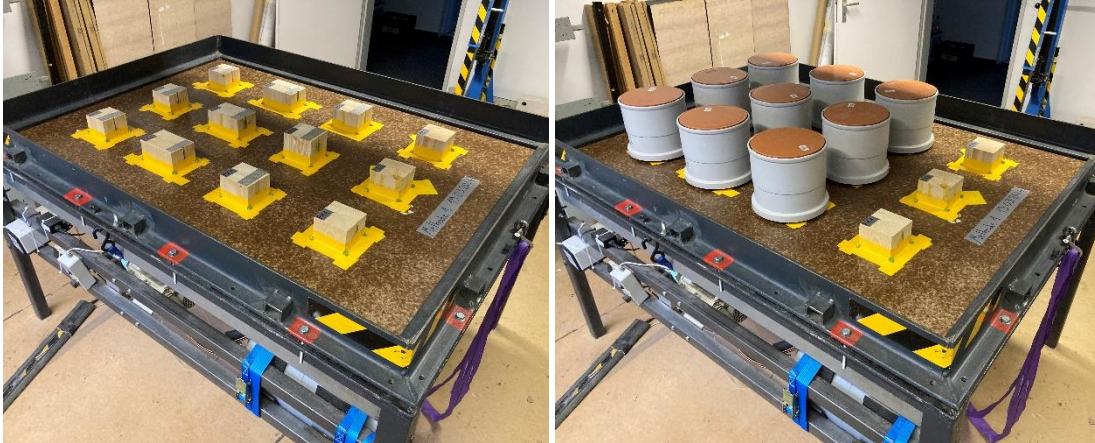
Abbildung 2: Messung einer angewendeten Abdichtungsmethode an allen Prüfkörpertypen (links) und Messung einer angewendeten Abdichtungsmethode an einem einzelnen Prüfkörpertypen (rechts)
