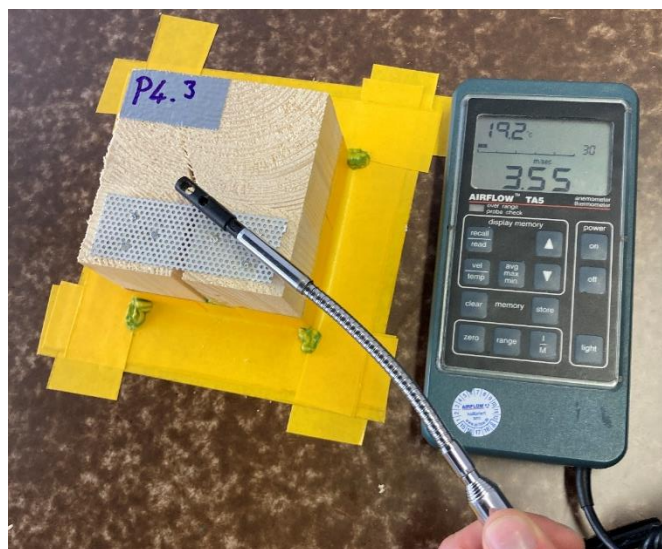
Abbildung 30: Dokumentation einer spürbaren Leckage mit Hilfe des Anemometers (AIRFLOW™ TA5)
