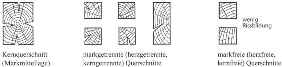
Abbildung 8: Mögliche Rissbildungen bei Vollholzquerschnitten in Abhängigkeit von der Einschnittsart 42
