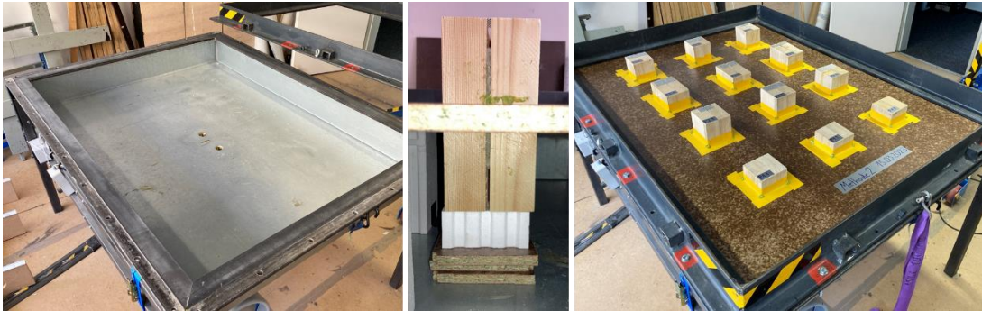
Abbildung 28: Messwanne (links), in der benötigten Höhe platzierte Prüfkörper (mitte) und allgemeiner Messaufbau mit angedichteten Prüfkörpern (rechts)
