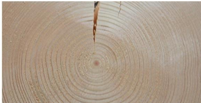
Abbildung 7: Trocken- bzw. Schwindriss 38
