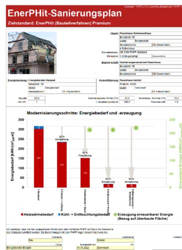
Abb. 2: EnerPHit-Sanierungsplan: Das Diagramm zeigt den mit jedem Schritt fallenden Energiebedarf. © PHI
