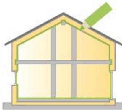
Abbildung: Stiftregel zur Planung und Überprüfung der luftdichten Ebene an einem Gebäudeschnitt. © PHI
