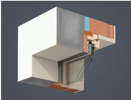
Fenster und Fassade sollten mit Blick auf Kosten, Wärmebrücken sowie die Optimierung solarer Gewinne gleichzeitig saniert werden. Wenn das nicht der Fall ist, folgende Hinweise:
