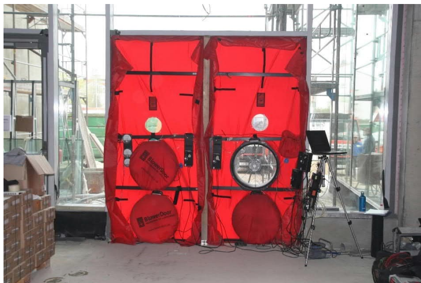
Fig. 8 Mesure de l'étanchéité à l'air de Bambados : En raison de la très bonne étanchéité à l'air, l'ensemble du bâtiment a pu être mesuré avec un seul ventilateur.
