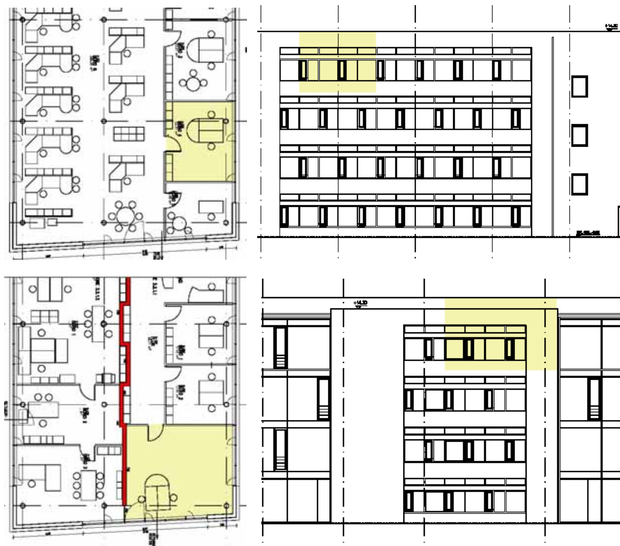
Abbildung 48: „Kritische“ Büroräume welche zur Bestimmung der Sonneneintragskennwerte herangezogen wurden (Oben: Ostbüro BA I; unten: Eckbüro BA II)
