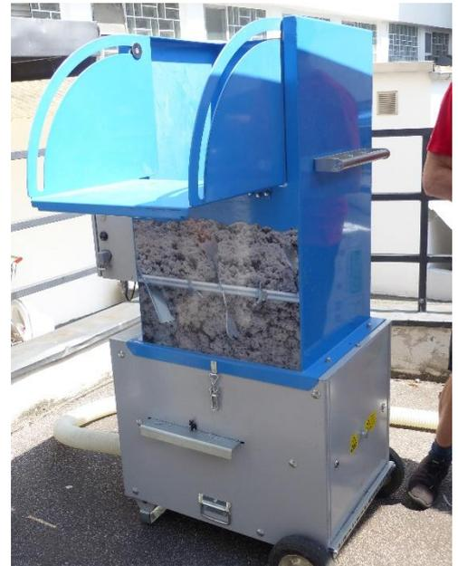
Abbildung 37: Einblasmachine
