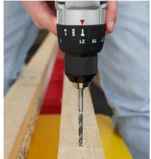
Abbildung 26: Vorbohren der Löcher
