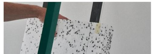
Abbildung 14: Schneiden der EPS-Platten mit einem Styrocutter
