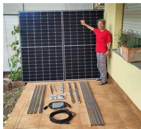
Abbildung 1: Module und Zubehör eines Stecker-Solargeräts. Unsere 385-Wp-Module sind 177 x 105 cm groß.
