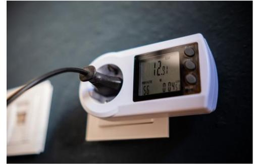
Abbildung 39: Strommessgerät als Adapter zwischen Steckdose und Stecker.
