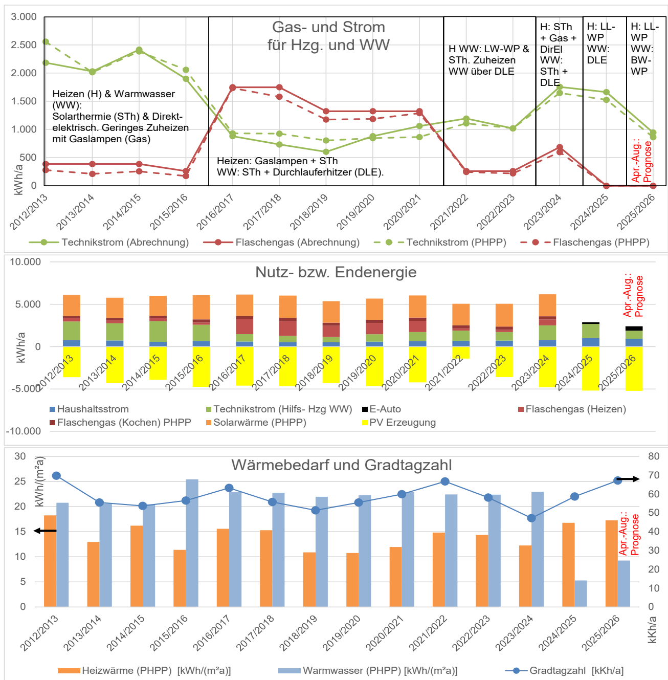
Abbildung 4: Gas- und Strombezug im Vergleich zum Bedarf nach PHPP (Oben). Nutz- bzw. Endenergie für relevante Anwendungen (Mitte). Heizwärme und Wärmegesamtnachfrage für Warmwasser lt. PHPP (Unten). Dargestellt ist jeweils die Zeitspanne September bis August. © Krick.
