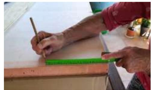
Abbildung 14: Anzeichnen der Schnittkanten.
