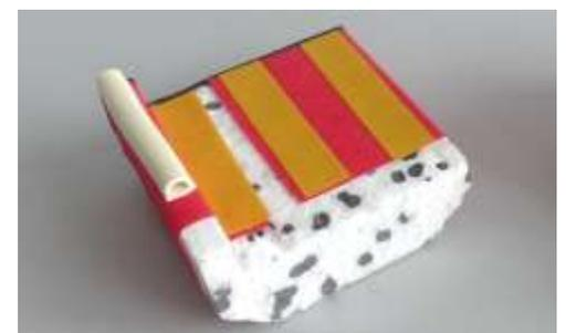
Abbildung 3: Musterstück aus EPS mit rotem Gewebeklebeband, doppelseitigem Klebeband und selbstklebender Fensterdichtung.
