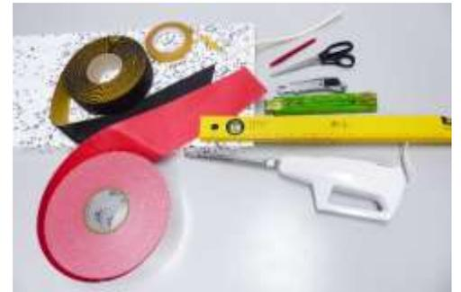
Abbildung 2: Du brauchst Dämmung, doppelseitiges Klebeband, Kautschukklebeband, extrabreites Gewebeklebeband und Fensterdichtung. Metermaßstab, Messer, Schere, Stift, einen langen, graden Gegenstand und ein Elektromesser oder Styroporschneider.
