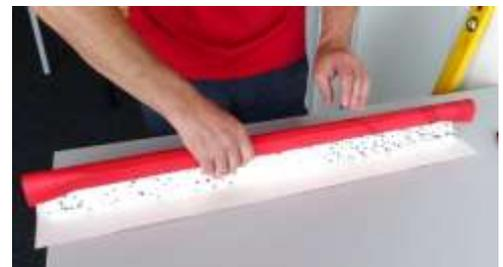
Abbildung 5: Aufkleben des Gewebeklebebandes.
