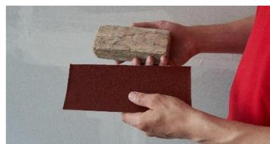
Abbildung 14: Schleifpapier mit Holzblock zum Schleifen der Oberfläche
