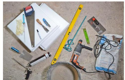
Abbildung 1: benötigtes Material und Werkzeug
