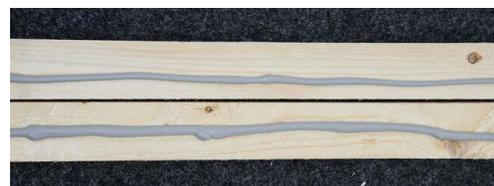
Abbildung 5: Kleberraupe auf die breite Seite der Dachlatten aufziehen...
