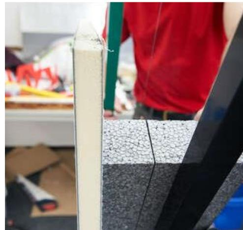
Abbildung 3: EPS-Streifen mit dem Heißdrahtschneider für die Verbundträger schneiden
