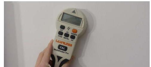
Abbildung 13: Sicherstellen, dass keine Leitungen im Weg sind!
