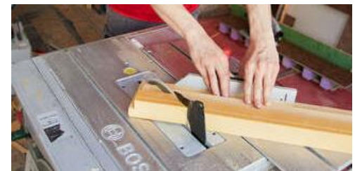
Abbildung 6: Profilenden auf Gehrung sägen
