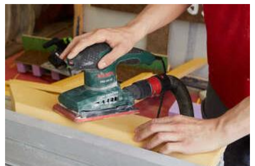
Abbildung 9: Aufrauen. Der Dämmschalen
