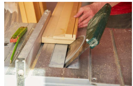
Abbildung 5: Profilieren der Dämmschalen.
